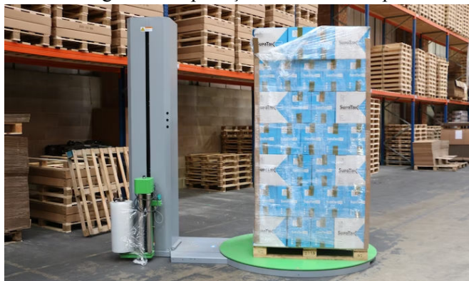
Figura 8 – Aplicação de stretch wrap
