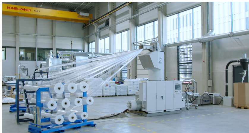
Figura 17 - Equipamento de reciclagem de stretch wrap da EREMA
