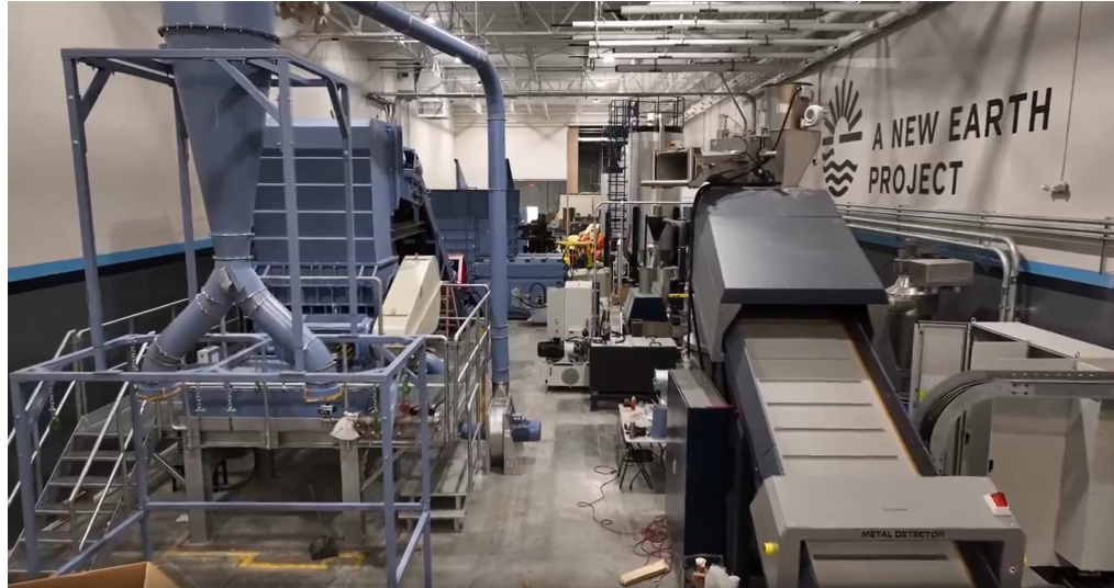
Figura 15 - Linha de reciclagem de stretch wrap da Atlantic Packaging
